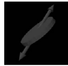
(c) せん断型ひび割れ
