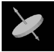
(a) 引張型ひび割れ
