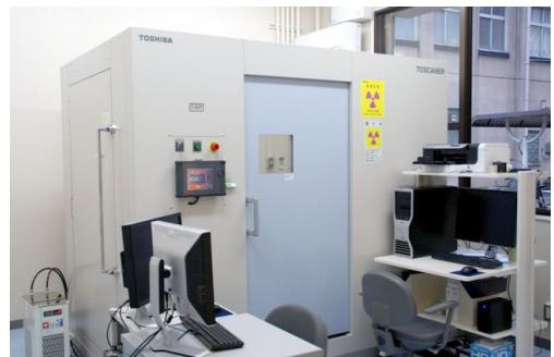
写真1 マイクロフォーカス型X線CT装置
