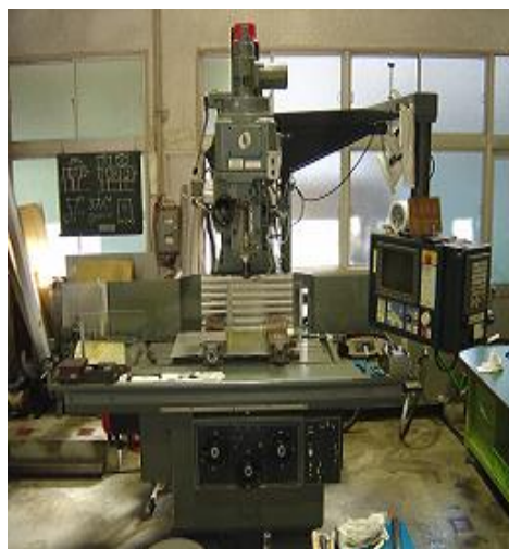
牧野フライス製作所製 NC フライス盤 写真2
