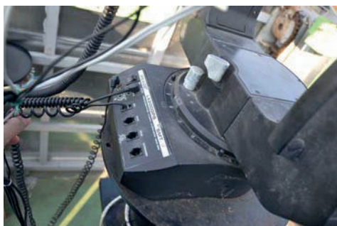
図9 ミード望遠鏡の通信ケーブル接点部
