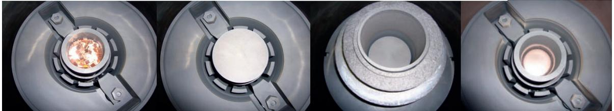
図 2.抵抗加熱；原料チャージから実験終了までの様子
