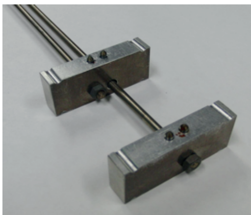
Fig. 7 伸び計の試験片挿入部
