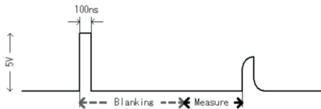
図2 反射波による伝送遅延時間測定概念図
