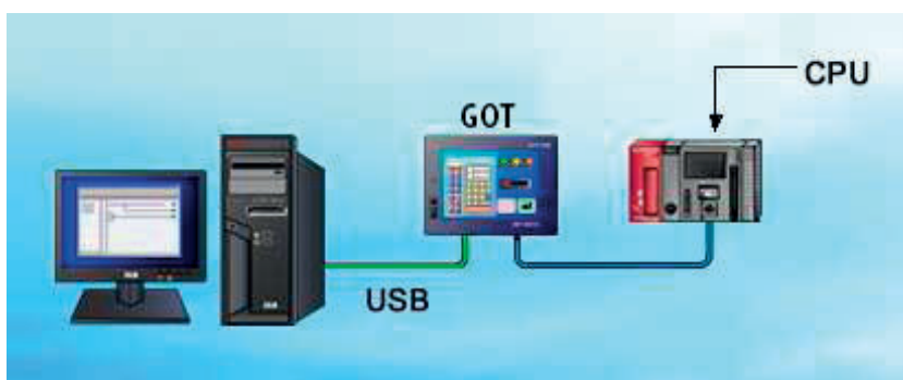
図 2 開発環境、PLC および GOT 接続
