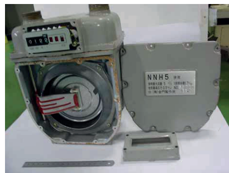
図4 ガスメーターの内部
