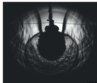
図 7 水中衝撃波の可視化 (シャドウグラフィ法)
