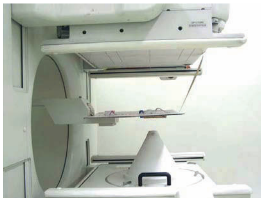
図 1 ピンホールコリメータを装着したガンマカメラ
