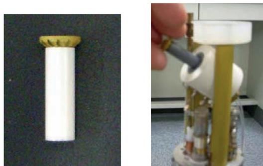
図 2 固体プローブ用サンプル管及びプローブへの挿入
