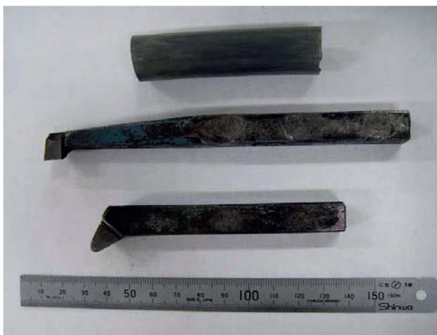
図2 普通旋盤実習で使用するバイト
