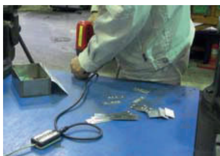
写真 1 L 字金具など固定部品の自作
