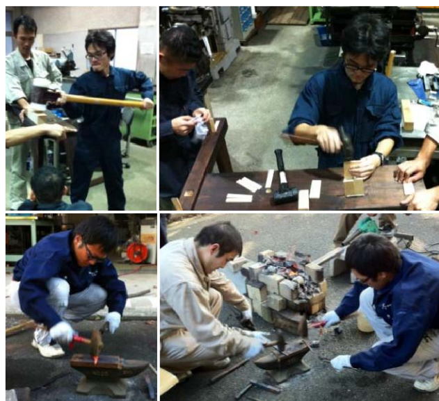
図7. 組み立て作業（上段）と刃物づくり（下段）
