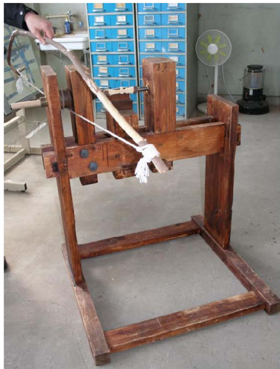
図 9. 弓駆動式木工旋盤
