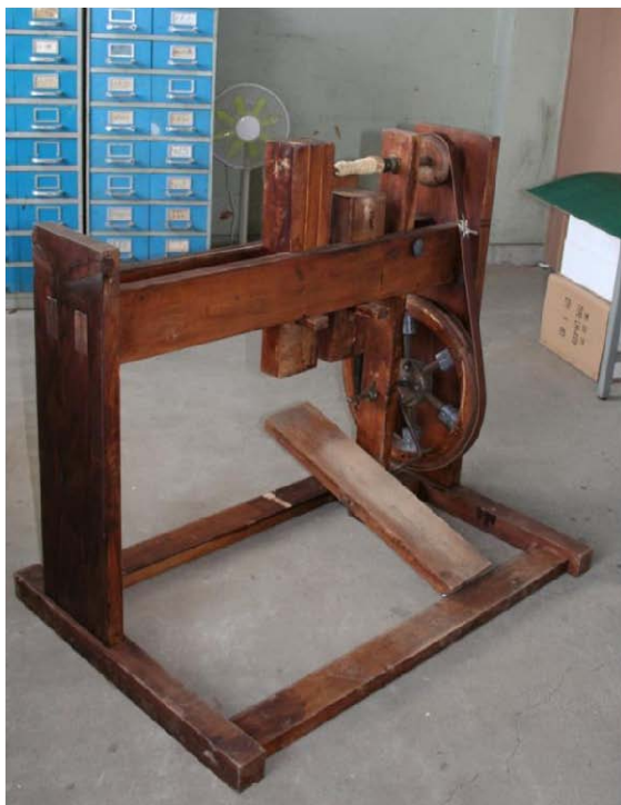
図 8. はずみ車式木工旋盤
