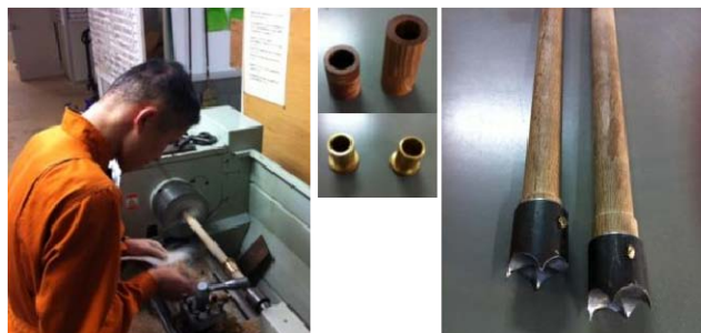
図5. はめ合い調整のための旋盤加工と軸受，主軸
