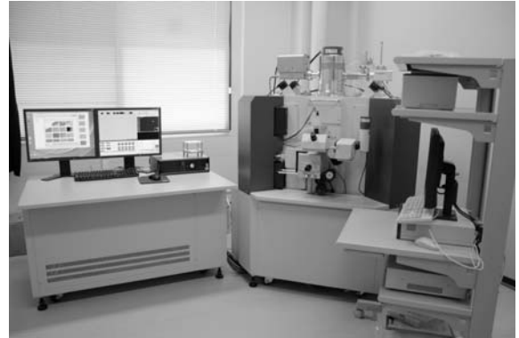
図 1 島津製作所製 EPMA-1720H
