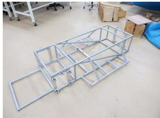
図4 完成したソーラーカーのフレーム
