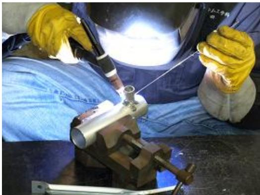
図2 溶加棒を使った溶接風景
