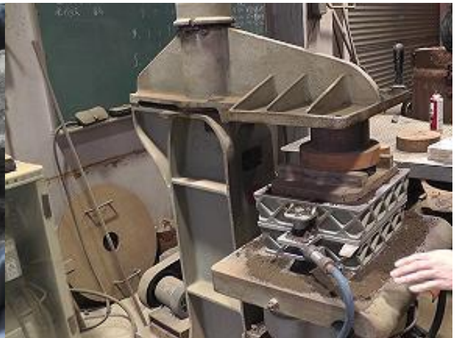
図4 造形機による型込め
