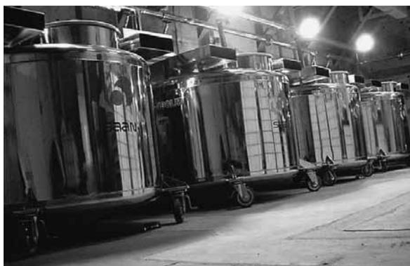
写真2 マウス胚・精子を保存するための大型液体窒素保管器
