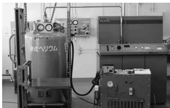
写真3 1984年に導入されたヘリウム液化機 左にあるのは2,000リットルの液体窒素貯槽(KOCH model 1410)
