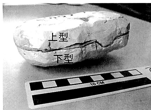
図4 雌型A。支持型を大きくして、高価なシリコン樹脂の使用量を少なくできるという特徴を持っている。
