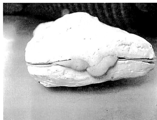
図6 雌型Aから余分な石膏がはみ出している様子。はみ出した材料の石膏が支持型に付着してしまい、上型と下型が離れにくくなる。
