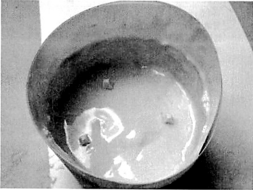
図18 シリコン樹脂の上にツメを乗せた状態。シリコン樹脂が固まりかけた時に、ツメをシリコン樹脂の上に乗せる。
