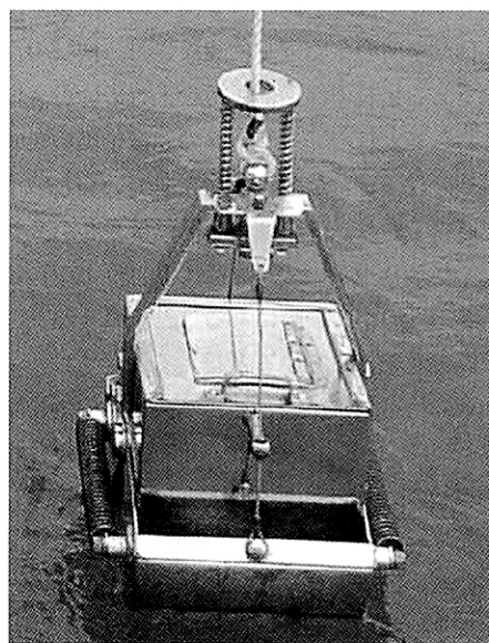
図 1 エクマンバージ採泥器
