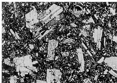
写真-4 中岳古期山体溶岩の顕微鏡写真 pl(斜長石) cpx(普通輝石) ol(カンラン石) (写真横幅2mm)
