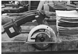
図3 電動丸鋸と裁断した杉板
