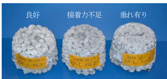
写真2 良好となる練り上がり状態
