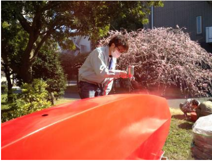
d) 面が仕上がったので本塗装へ スプレーガンも様になっている
