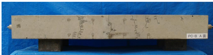
写真3 せん断試験(PC-B) ひび割れ及び終局的破壊性状
