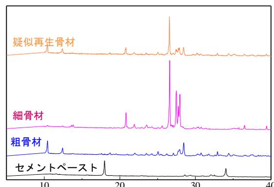
図-3 塩酸溶解後 XRD 結果
