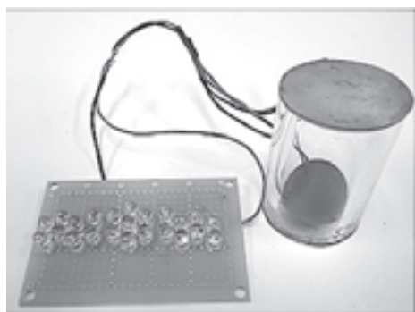
図6 手で振ることによって発電する教材
