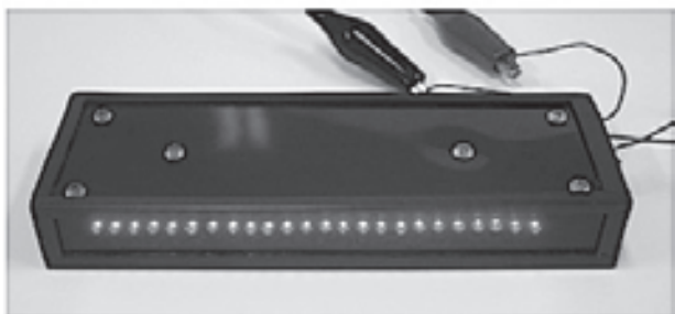
図10 蓄電電圧用レベルメータ
