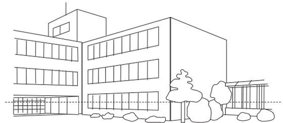
図10 二点透視図法の例
