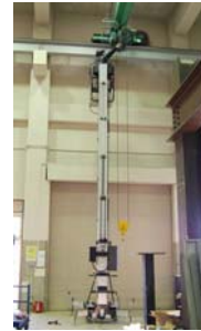
写真 1 高所作業装置による点検
