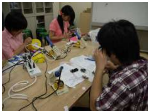
写真1 ゲルマニウムラジオによる受信 第2回に電池のいらぬラジオを作り、屋外で受信実験を行った。アンテナの向きによって音量が異なることを体験した。
