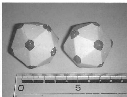
図8 河床礫モデルとして使用した多面体石膏礫。
