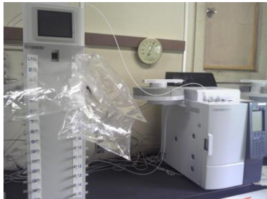
図4 自動ガスインジェクタ（左）と接続したガスクロマトグラフ装置（右）
