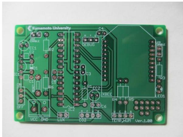
図 3. 子機プリント基板
