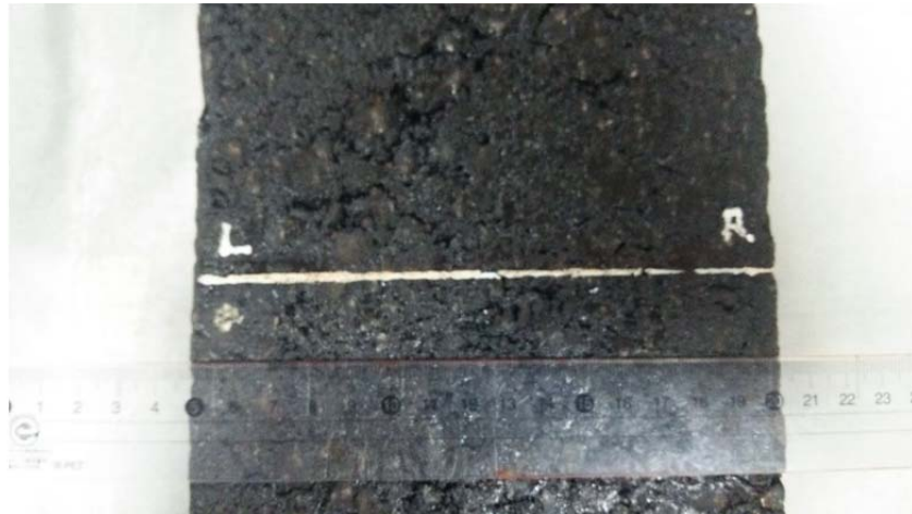
写真－6.4 6,000回載荷後におけるW1の供試体裏面
