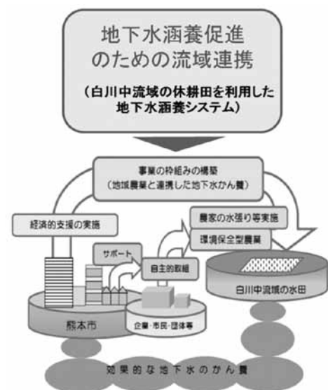
図-2 熊本地域における白川中流域の休耕田を利用した地下水涵養システム。 資金源の地下水ユーザーは熊本市にいて、涵養効果のある中流域低地は大津・菊陽町という熊本市郊外の異なる行政地域にあるので、行政境界を越えた地下水管理の好事例として注目される。
