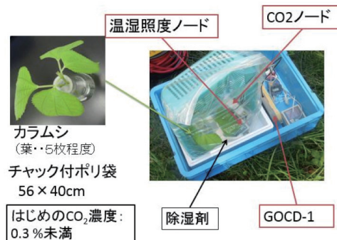
図5 カラムシでの CO2 濃度変化測定の実験セット 実験機器の詳細は材料と方法参照.
