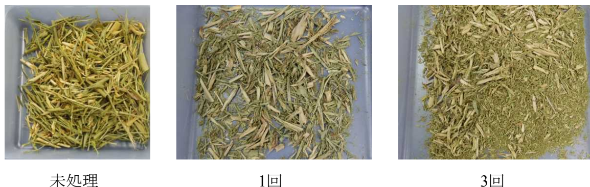
Figure 5-6. 水中衝撃波(3.5 kV, 4.9 kJ, Al Wire 1.2mm \phi , ギャップ 10 mm)による瞬間的高圧処理を行った月桃葉
