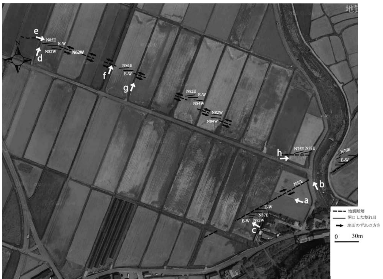
図 3 下陣地域に出現した 2 系列の地表地震断層 (a~h は写真撮影地点)
