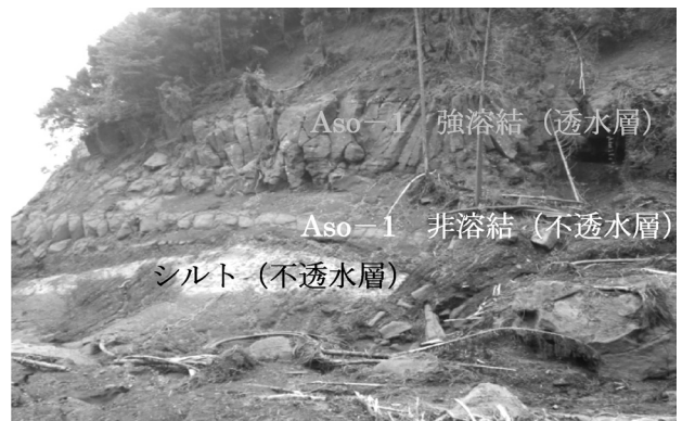
写真-15 滝上部のAso-1の強溶結部とシルト岩
