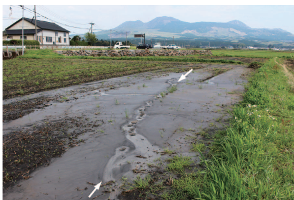
図 20 阿蘇谷北西部の水田で認められた噴砂跡 (阿蘇市車帰).
