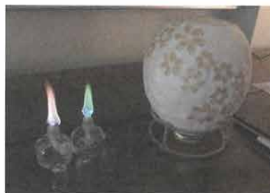
図7 炎色反応を利用したアルコールランプ照明。
