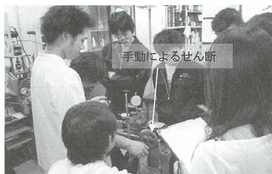
図4 手動式試験器による土のせん断試験
