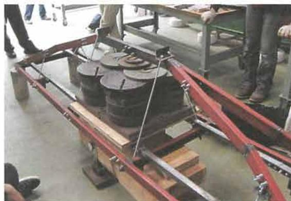
業大学で行われた。この大会には13大学から15チームが参加して、それぞれ独自の橋模型の性能を競った。橋梁形式はトラス、単純桁それにアーチなどであった。熊本大学は初出場だったが、競技では架設時間22.8分、重量48.2kg、載荷時のたわみが5.44mmで、全体の成績では、架設部門で7位、構造部門で6位、プレゼンテーション部門が4位そして美観部門が1位となり、総合で5位という輝かしい結果を残すことができた（詳細は別ページに報告）。
