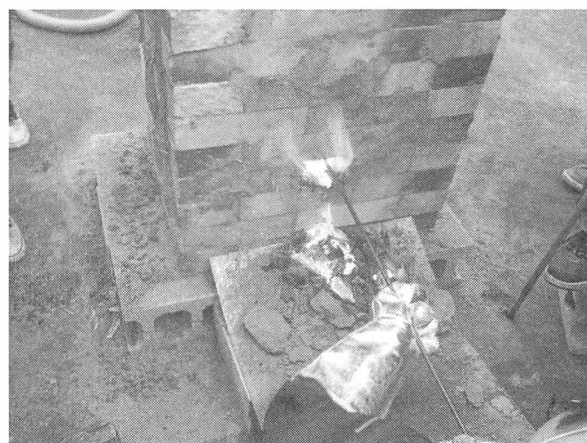
図3 1号炉のノロ出し、ノロが過過ぎていた
