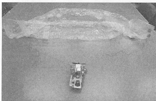
図4 製作した Cansat (パラグライダータイプ)
