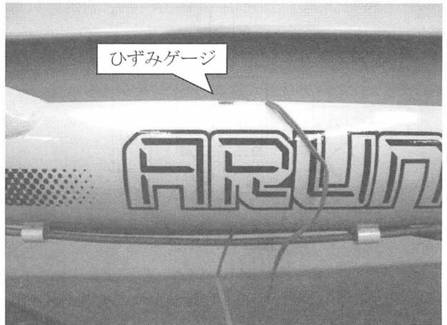
図6 ひずみゲージを用いたひずみ測定部
