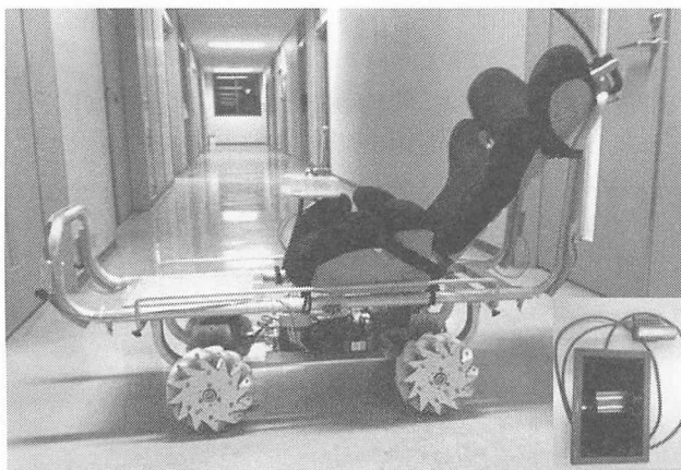
図5 製作した障害児移動用のカート
