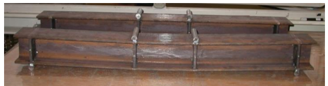
写真 1 鋼はり試験体(H-100x100x6x8) (2011 年度)
