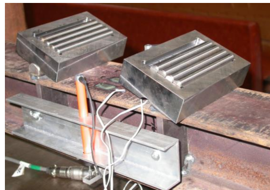
写真 5 試験体載荷部ピンローラー治具 (2013 年度)
