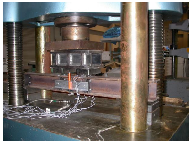
写真 2 鋼はりの弾塑性曲げ実験 (全景) (2013 年度)
