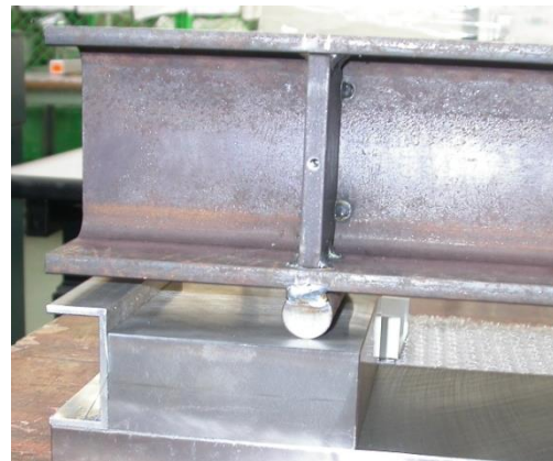
写真 3 試験体の左端部の支持状態 (2011 年度)
